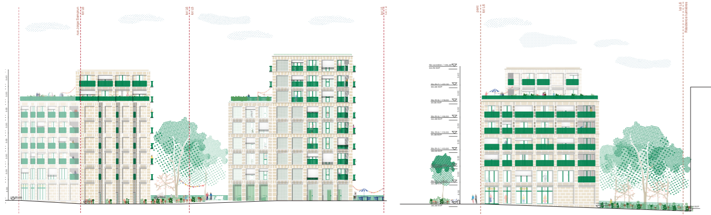
Les Façades en pierre porteuse
